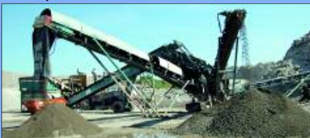
In modernen Brecheranlagen wird Bauschutt recycelt
