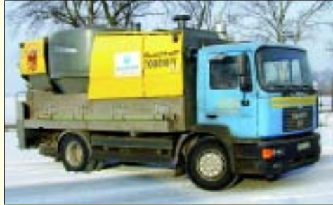
Herz des Unternehmens ist die fahrbare Mahl- und Mischanlage, die vor Ort Getreide in den landwirtschaftlichen Betrieben verarbeitet
