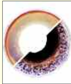
Bei TV-Inspektion gefundener Wurzeleinwuchs (li.) Vor und nach der Sanierung (re.)
